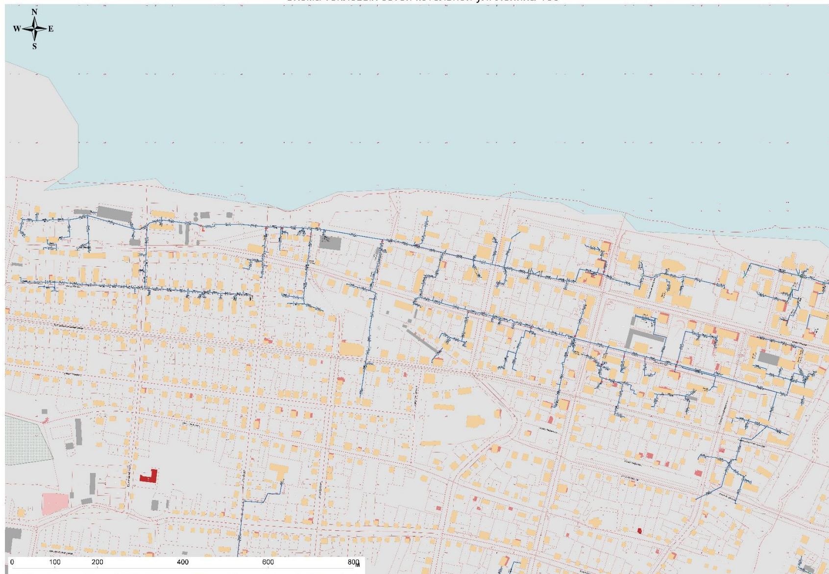
Схема тепловых сетей котельной ул. Ленина 160
