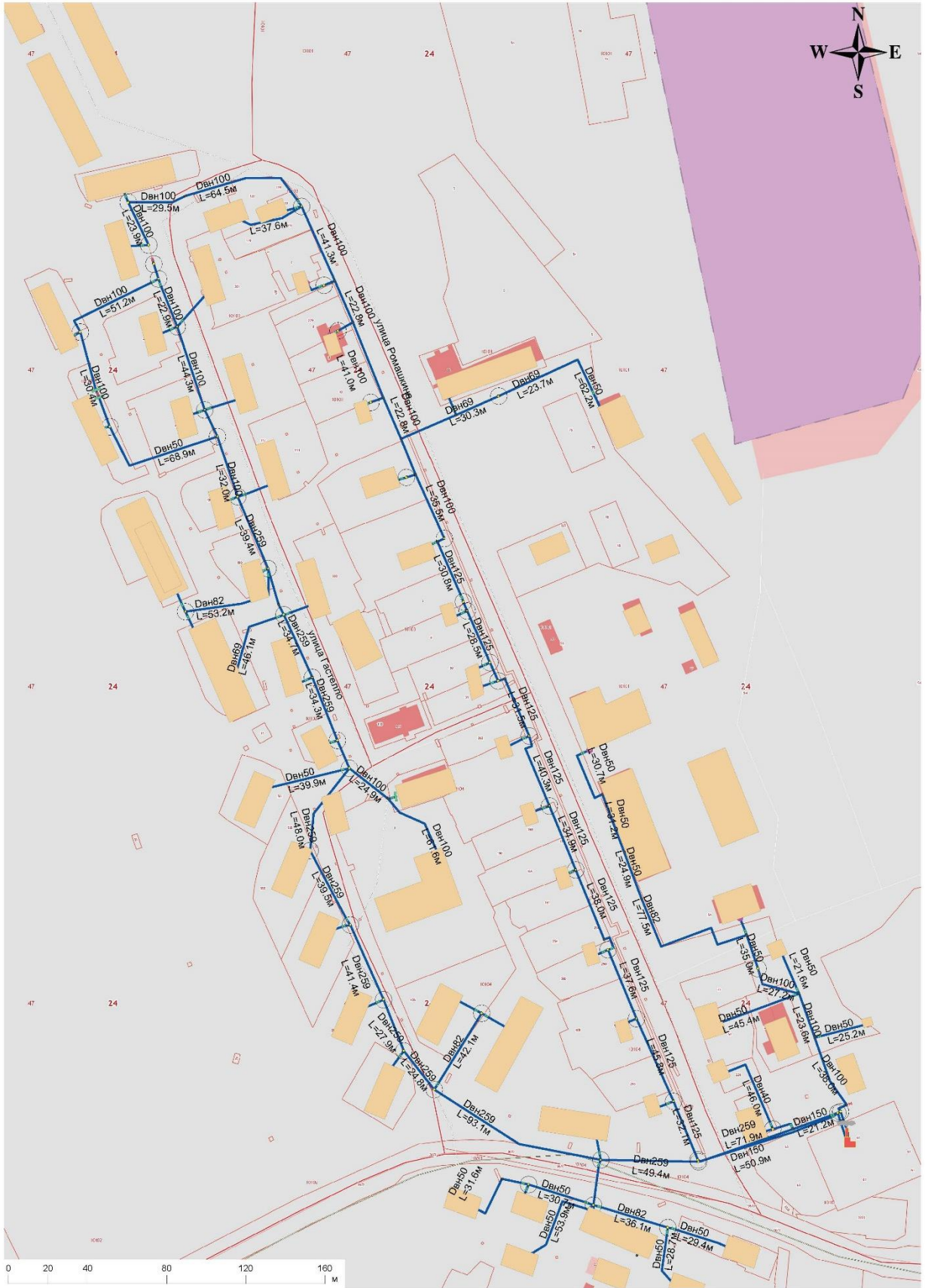
Схема тепловых сетей котельной ул. Ромашкина 2А
