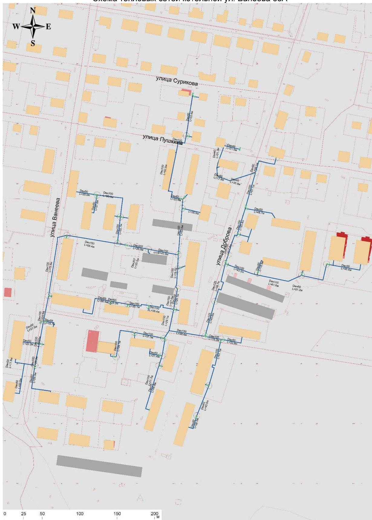
Схема тепловых сетей котельной ул. Ванеева 63А
