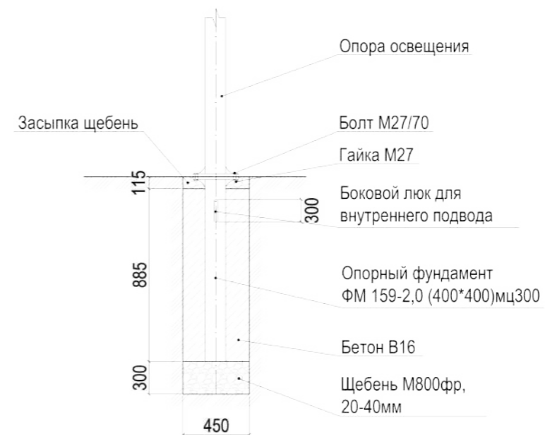
3.16 Схема монтажа опоры освещения
