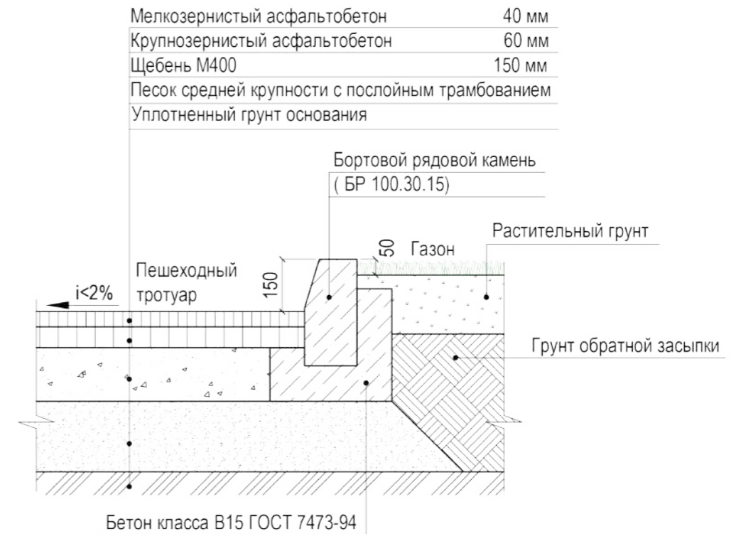
3.13.1 Схема устройства сопряжения асфальтобетонного покрытия и газона
